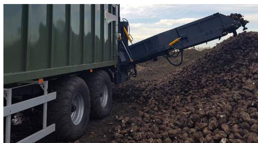
Регулируемая высота выгрузки свеклы до 3,5 м.
