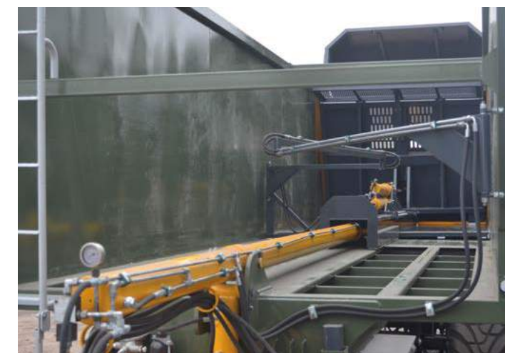
Гидравлическая система сдвижной стенки
