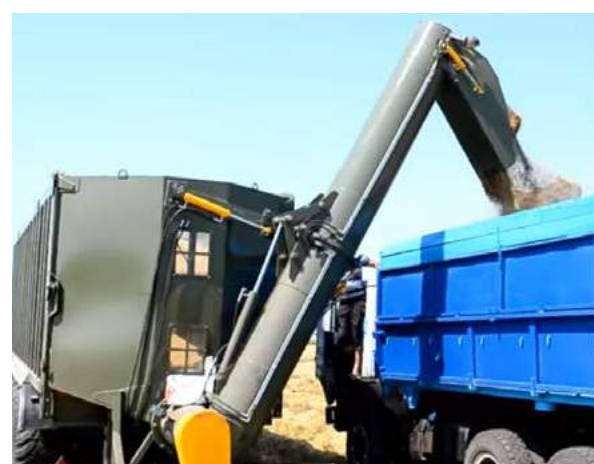
Гидравлическое изменение угла разгрузочного шнека
