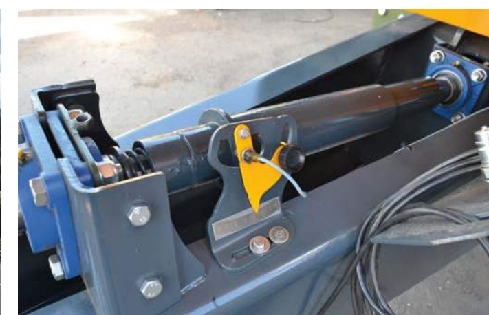
Торсионный регулятор нагрузки
