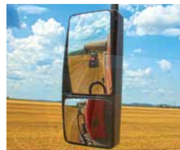
Регулируемый обзор с помощью двухсекционных зеркал заднего вида
