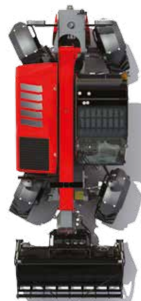
Управление всеми колесами - для минимального радиуса поворота
