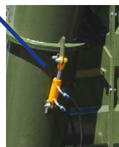
Гидравлический замок фиксатор двух частей шнека.
