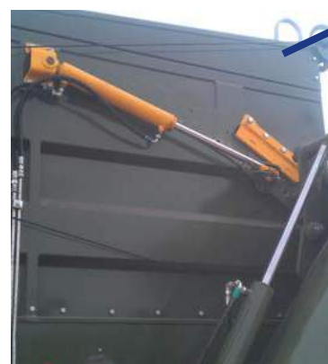
Гидравлическая смена угла выгрузного шнека (опция)
