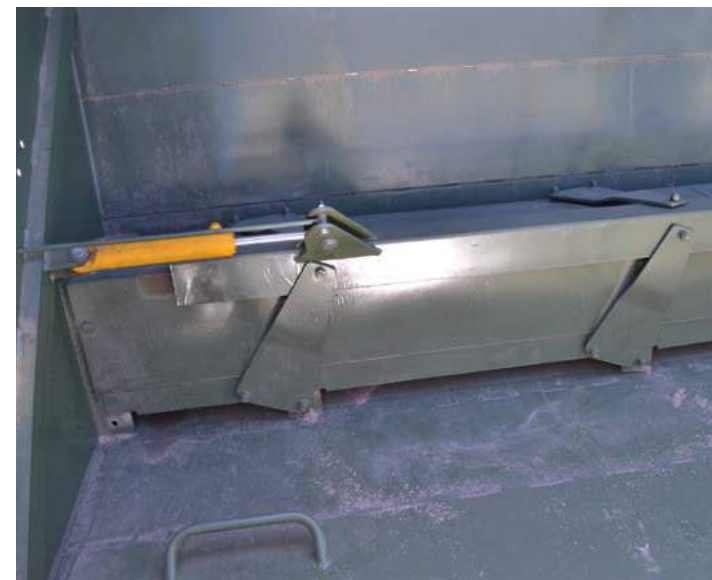
Гидравлически открывающаяся шиберная заслонка. Подает зерно в шнековый транспортер.
