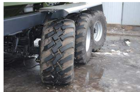
Гидравлически подруливающие первая и последняя оси (ПБН-40 и ПБН-50).
