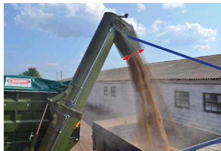
Гидравлический козырек шнека (опция) направляет поток зерна. Равномерно загружает автомобиль под левый и правый борт
