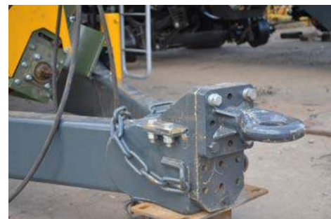
Адаптер для регулирования высоты прицепления под любой трактор
