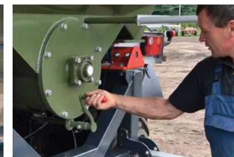
Винтовой механизм открытия очистных заслонок горизонтального шнека
