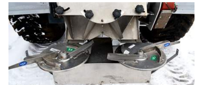
Нержавеющие тарелки с гидроприводом – ширина внесения 24 (36) м
