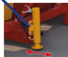
Гидроцилиндр для стабилизации центра тяжести
