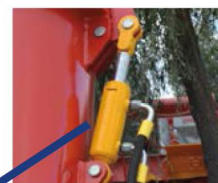
Гидравлический замок фиксатор двух частей шнека
