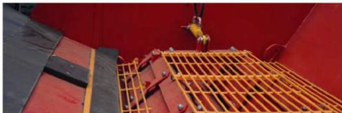
Гидравлически открывающаяся шиберная заслонка. Подает зерно в шнековый транспортер.
