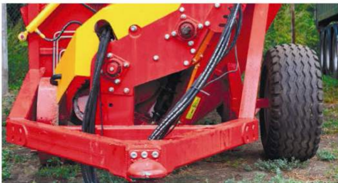
Дополнительные передние колеса установлены для транспортировки зерна в бункере
