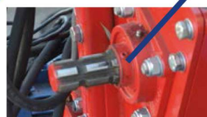
Шлицевой выход для привода от ВОМ трактора
