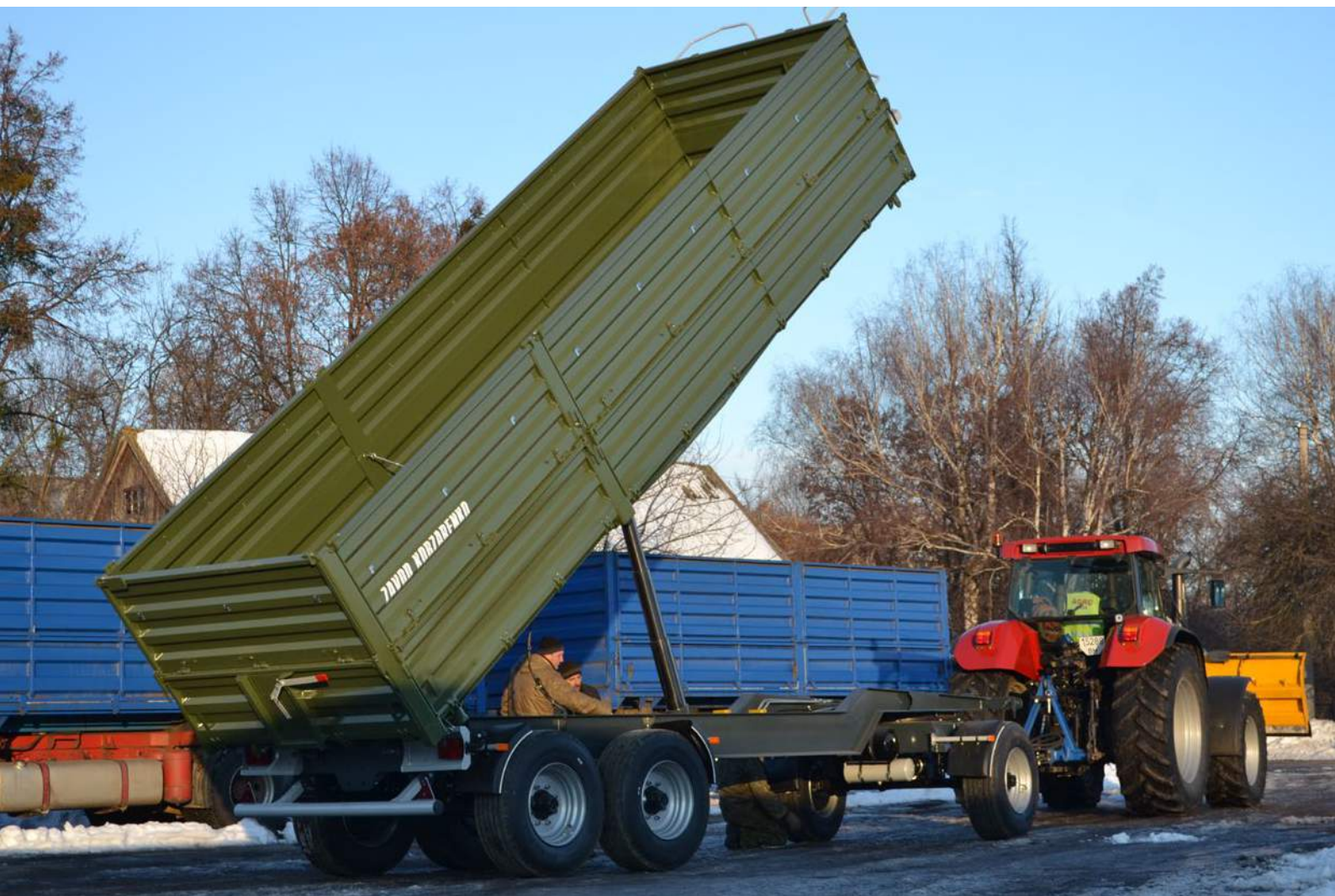
Прицеп ЗТСП-24 с трехсторонней разгрузкой
