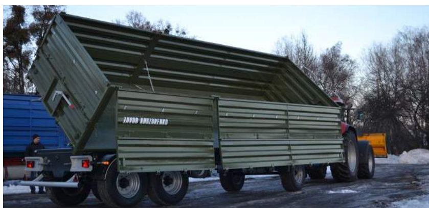
Прицеп ЗТСП-24 с трехсторонней разгрузкой
