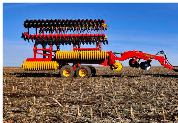
В Carrier XL 925-1225 используется уникальная система складывания Väderstad. В сложенном виде транспортная ширина машины составляет 3 м.
