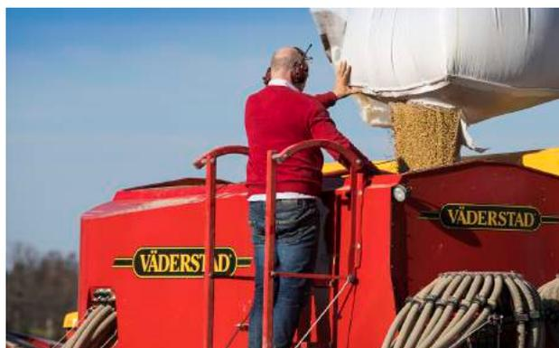
*Комбинированная модель (Spirit 600-900C) имеет вместительный 5000-литровый бункер, а объем бункера обычной версии (Spirit 600-900S) – 3900 литров.*
