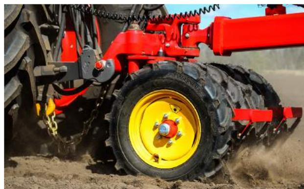
Поворотный межколесный каток уплотняет почву между колесами трактора, обеспечивая равные условия для всходов.
