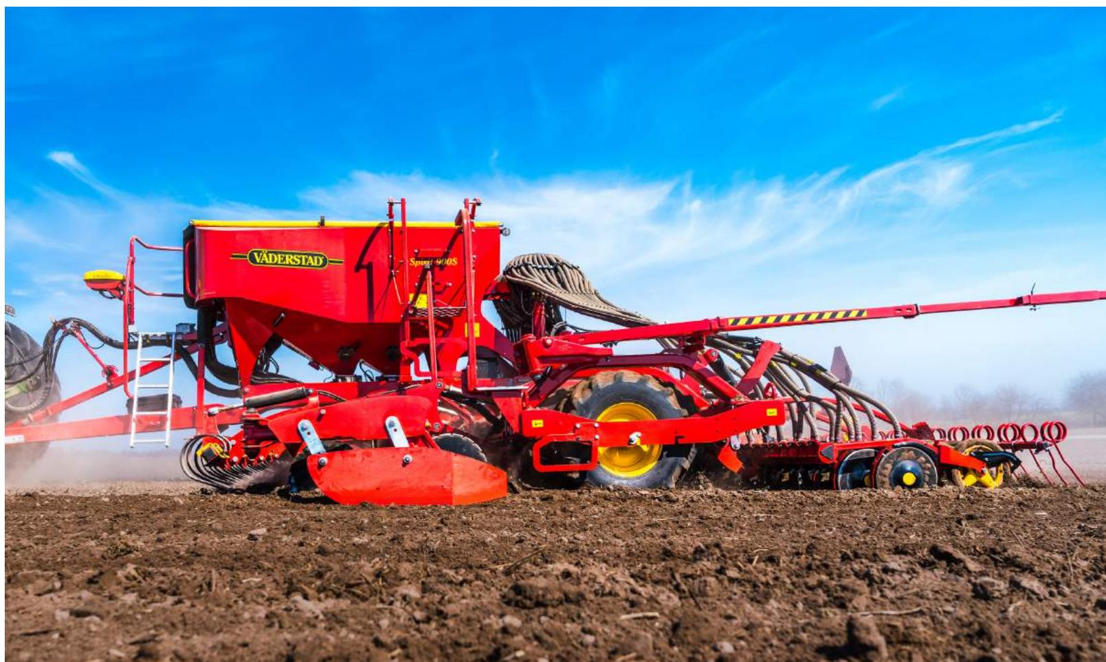
Пневматическая сеялка Spirit 600-900 доступна в двух версиях: только для сева (Spirit 600-900S) и с внесением удобрений (Spirit 900-900C). Она представлена моделями с шириной захвата в 6, 8 и 9 метров.
