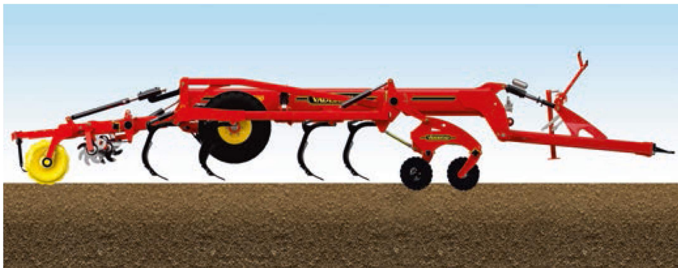
Поверхностная культивация – работают только диски и каток.
