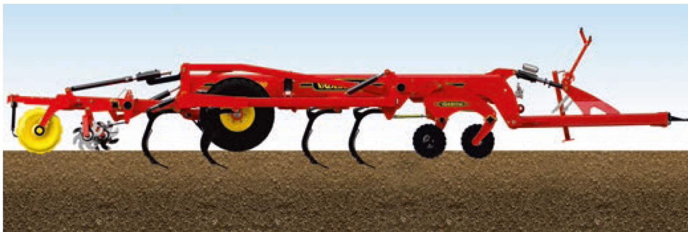
Подготовка семенного ложа за один проход – работают все рабочие органы.
