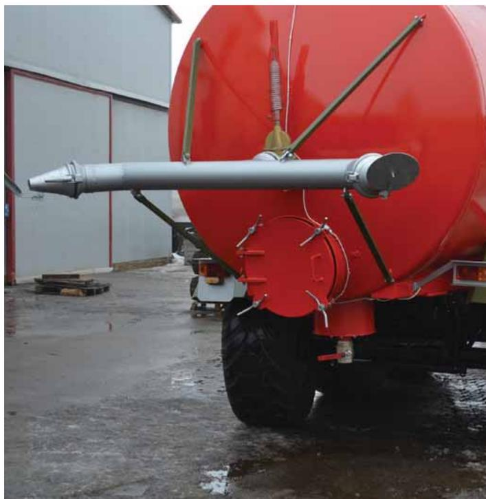
Поверхностное внесение через эжекторный распределитель проводится нагнетанием давления, в результате чего навоз, через заднюю заслонку, под давлением ударяется об тарелку и распыливается на ширину 12 м. Ширина и норма внесения регулируется гидравлической задней заслонкой и углом атаки тарелки, который является переменным. Это наиболее экономичный и быстрый способ внесения.
