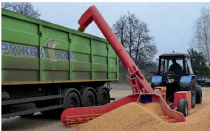
Перегрузка зерна в зерновоз с помощью НРУ-180
